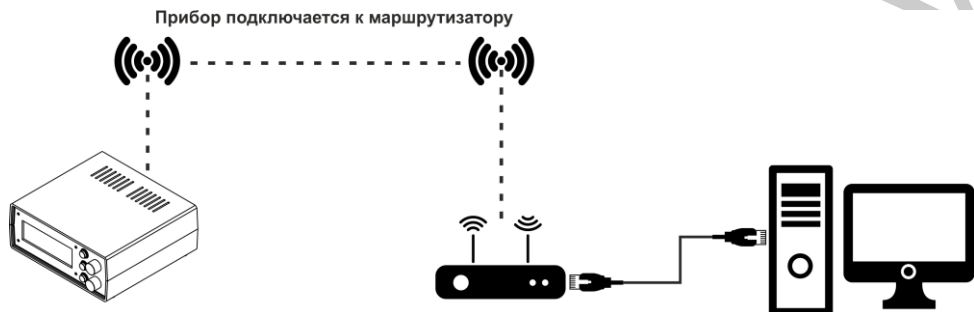
Рисунок 16. Подключение компьютера к прибору через маршрутизатор
